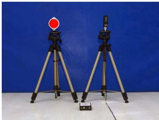
Slika 20. Sistem fotoćelija Fitro Gates (WEBA GmbH).
